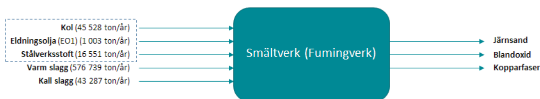
Figur 2. Övergripande beskrivning av Bolidens materialåtervinning (fumingprocess) i fallstudie 2.
