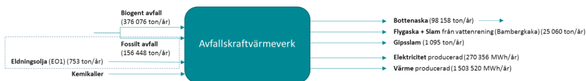
Figur 4. Övergripande beskrivning av Renovas avfallskraftvärmeverk i fallstudie 3.
