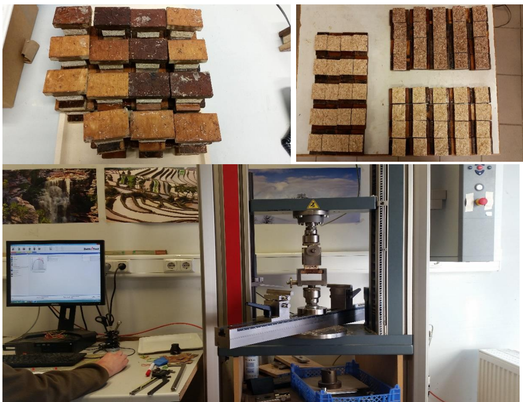
Figure 31. Determination of internal bond (IB) strength (EN 319).
