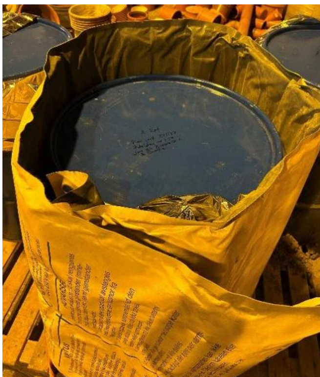
Figur 20. Tunnor inlindade i värmematta. Temperaturen mättes med en digital jordtermometer.
