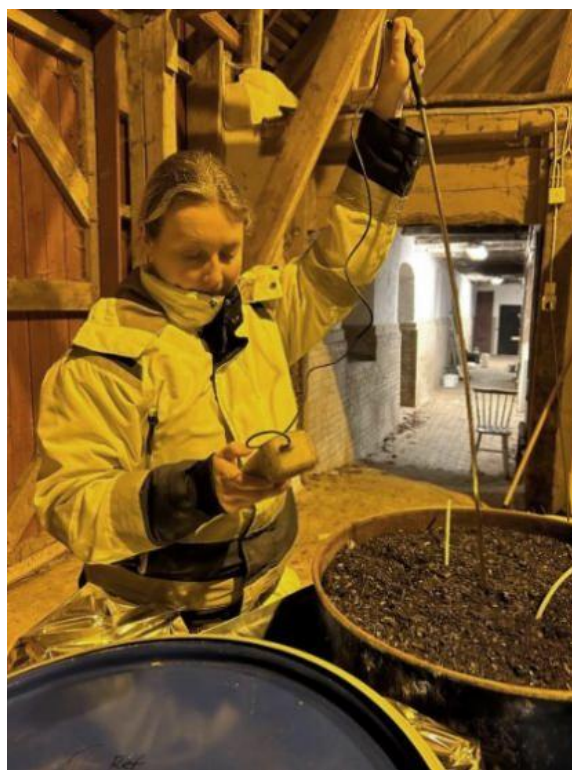
Figur 20. Tunnor inlindade i värmematta. Temperaturen mättes med en digital jordtermometer.
