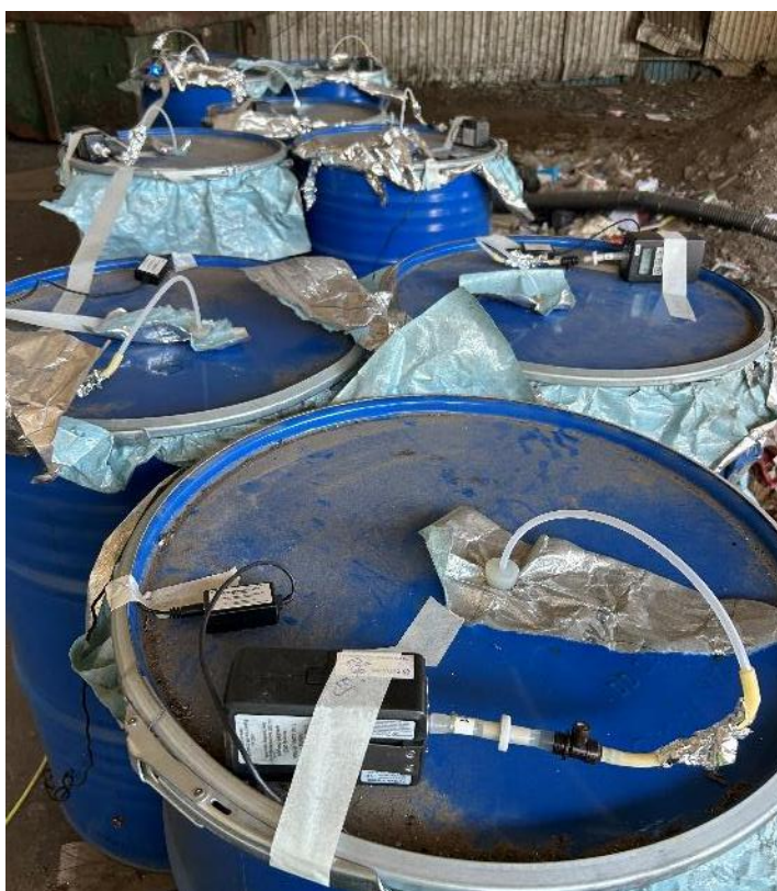
Figur 19. Fat med jord från Oceanhamnen. Koppling för provtagning av headspace. Pumpar och genomföring
