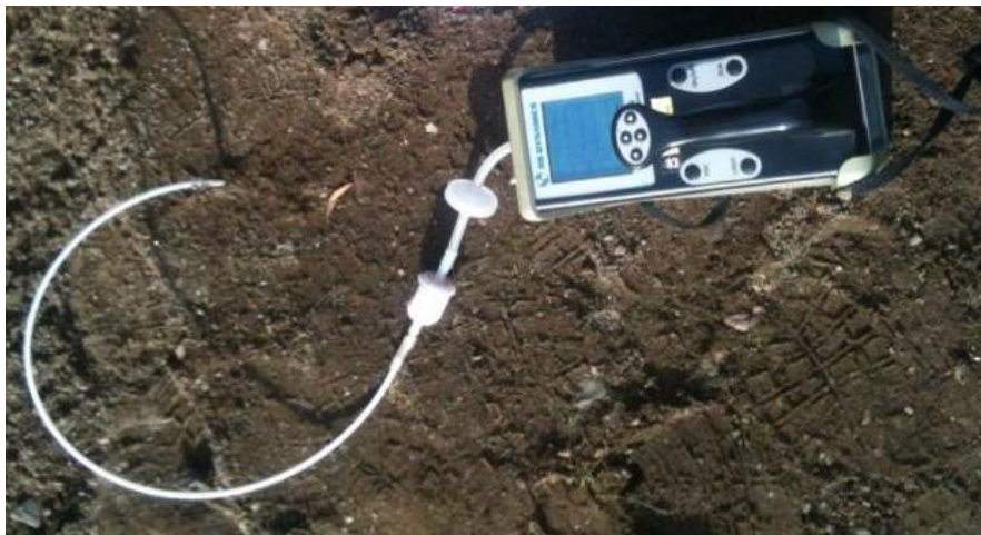
Figur 17. Multigasmätare (av typ Ecoprobe 5 från RS Dynamics) (foto: Pär Hallgren Sweco)
