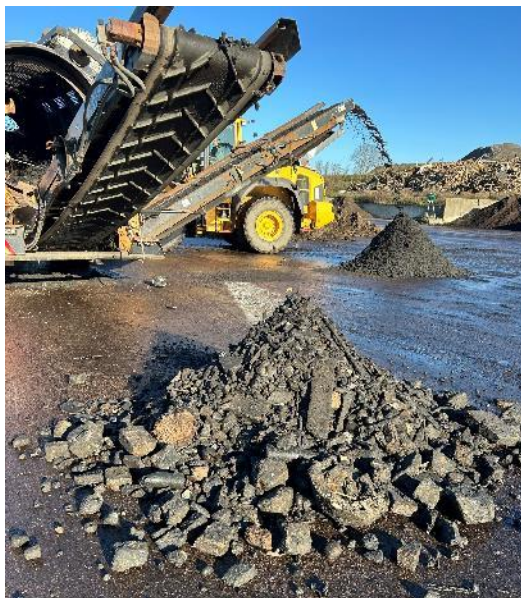
Figur 11. Siktning och inblandning av 8-11 singel (stenkross)
