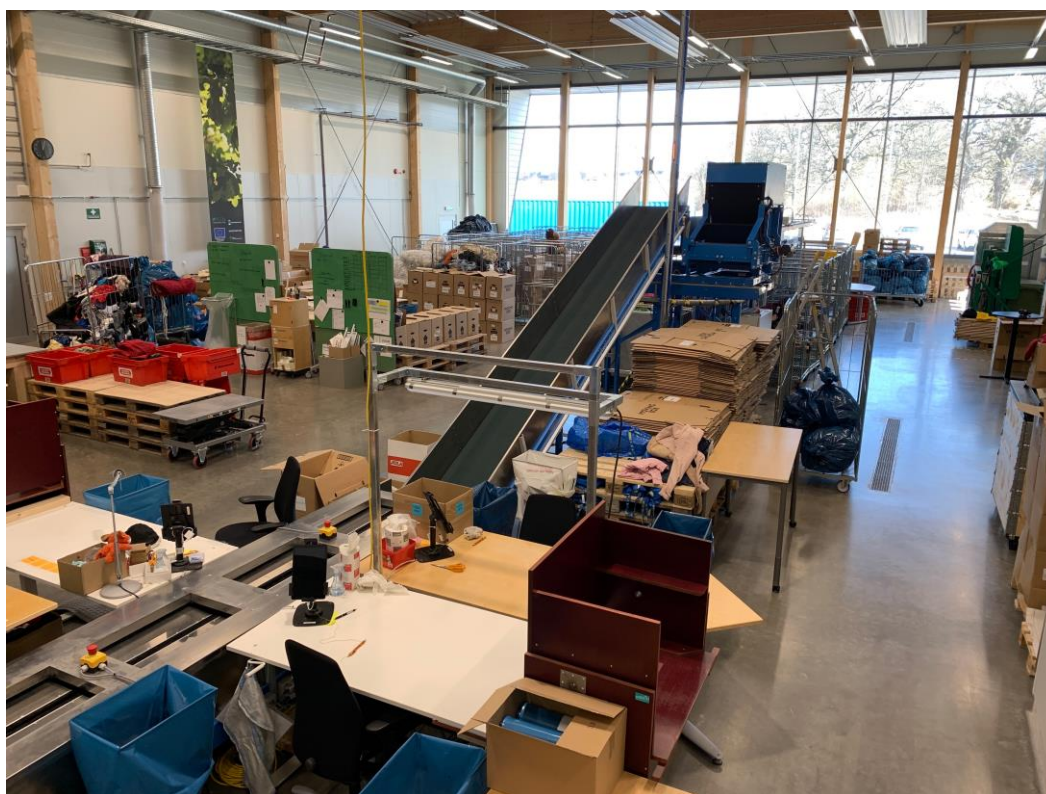
Bild 4. Sorteringsutrustningen, främre delen med textiltutvärderingsplatserna.
