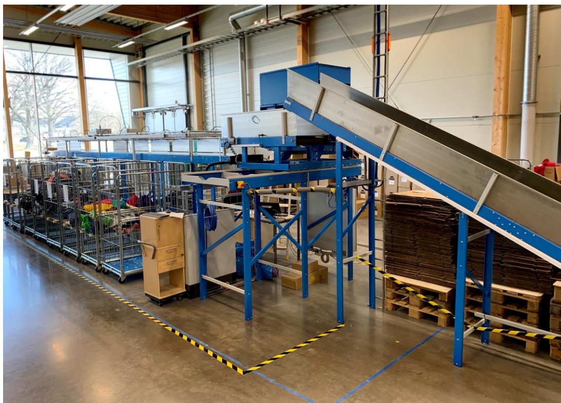
Bild 5. Sorteringsutrustningen, bakre delen med paddlar och rullvagnar.
