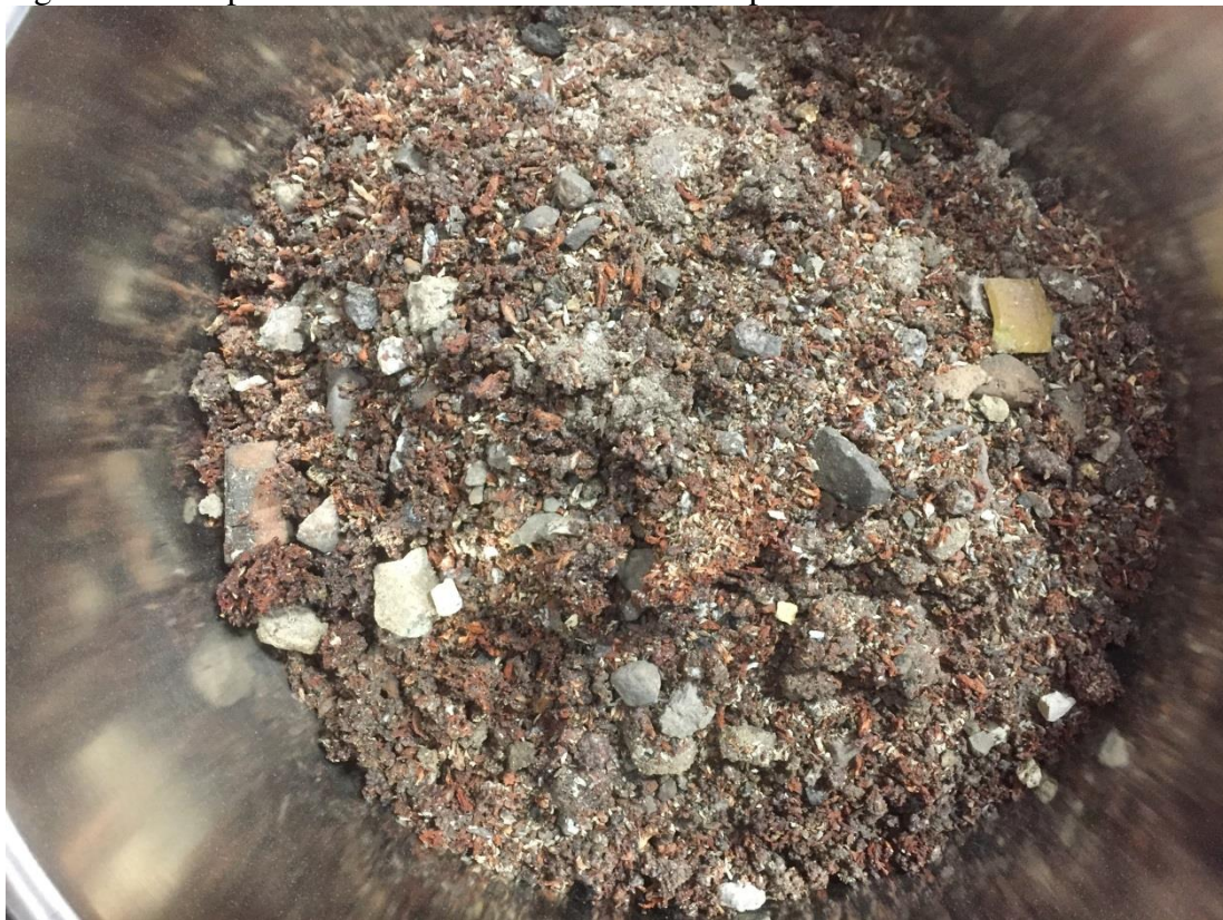
Figur 21. Bottenaska efter samförbränning av torkat avloppsslam med returträ i panna 6 (P6) i Vetlanda. Notera avsaknaden av stora ihop sintrade klumpar som var fallet för bottenaskan i Uddevalla, se Figur 19.
