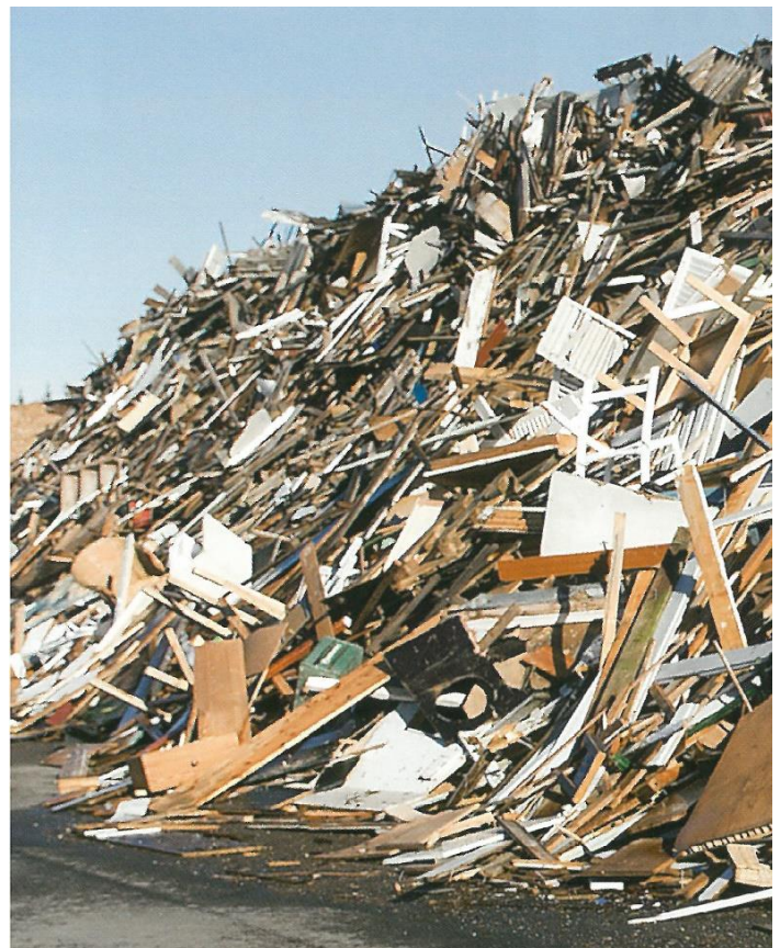
Figur 7. Sorterat returträ vid Flishults avfallsanläggning i Småland. Bilden är taget innan materialet går igenom en krossnings-anläggning med en metallavskiljare för beslag skruvar och spik.
