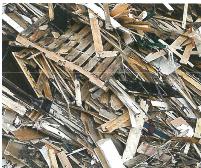
Figur 8. Förstörning av vad returträ består av. Bilden är taget innan materialet går igenom en krossningsanläggning med en metallavskiljare för beslag skruvar och spik.
