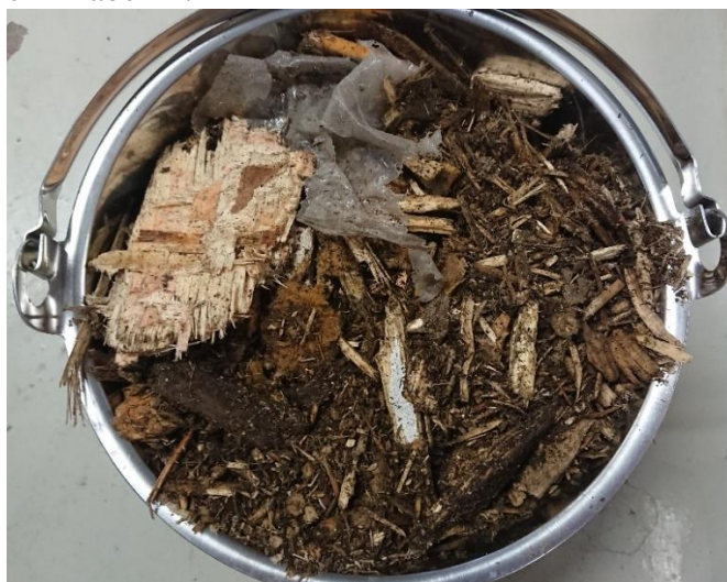
Figur 9. Krossat returträ i den form som det matas in på rosten. Notera resterna av emballageplast och storleken på plywood-bitar. Returträ kan också vara ytbehandlad, d.v.s. målat trä.
