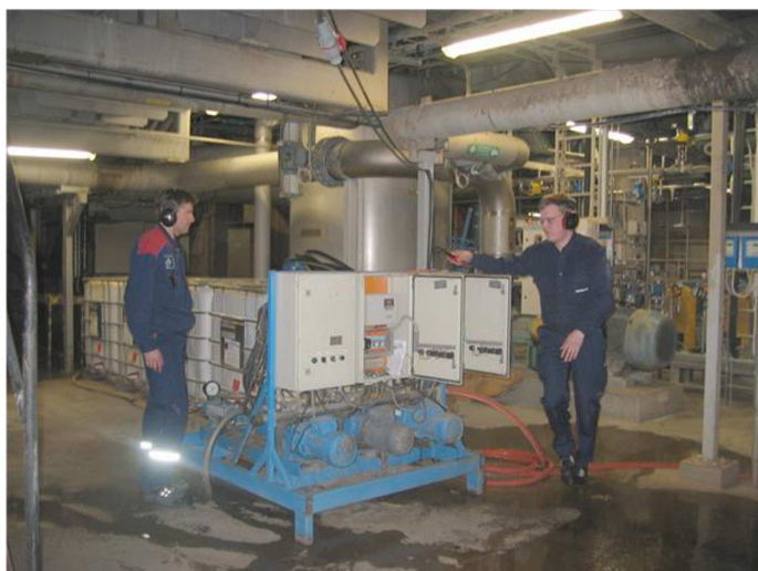
Bild 1. Arbete vid testanläggning på SCA Obbola pappersbruk. Analyserna avser att studera laktobacillernas effekt på slembildning i processvatten. Teknisk personal från pappersbruket deltar i arbetet.
