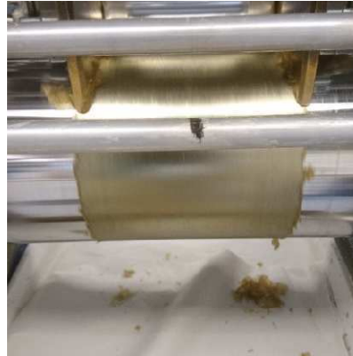
Figur 11: PVC pulver med BHET VA bildade en smält film som ändrade färg till mörkt brun
