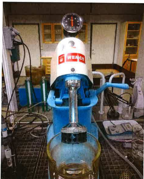
Figur 7. 3 liter Wemco-cell med mekanismen delvis lyft.
