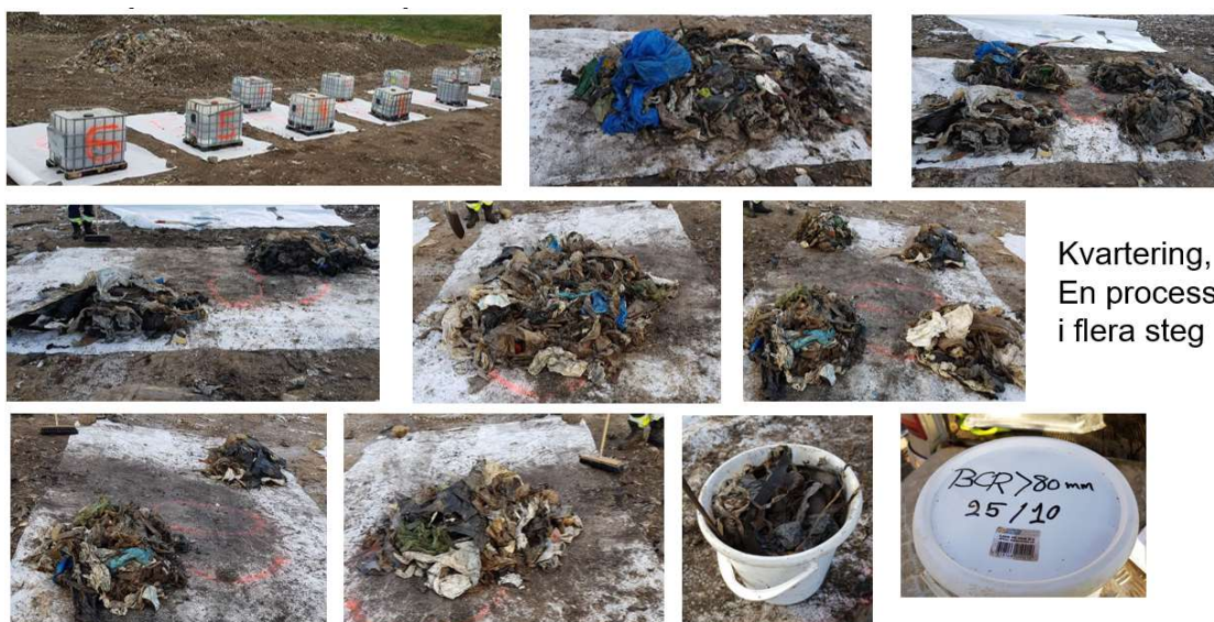
Figur 16. Uttag av representativa prover för bränsleanalys
