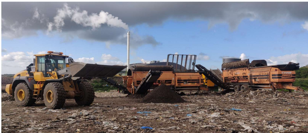
Figur 13. Uppställning, trumsiktar och vindsiktar, våren 2020
