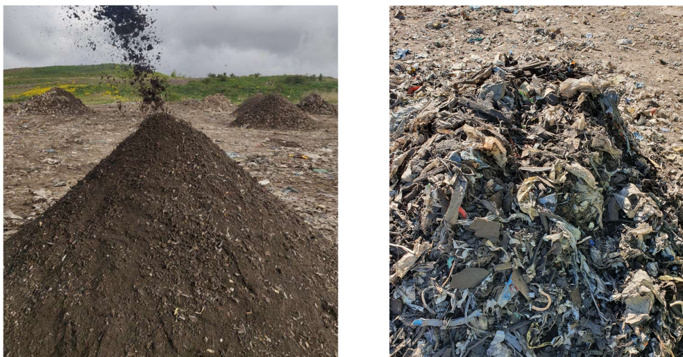
Figur 18. Finfraktion (<20 mm) och grovfraction (>80 mm) efter trumsikt och vindsikt
