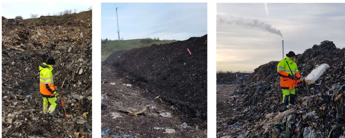
Figur 24. Metanmätning in situ (sniffning, porgassond, fluxbox), Sweco, 2018
