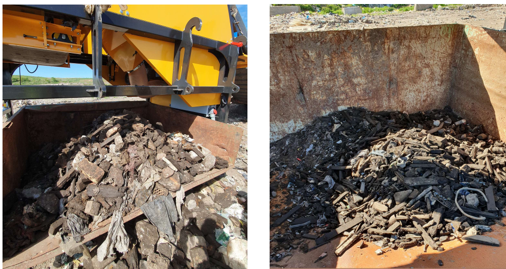
Figur 19. Tunga fraktioner efter vindsiktning, > 80 mm respektive 20-80 mm
