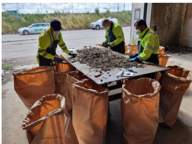
Figur 17. Plockanalys av de tunga delfraktionerna efter vindsikt, 20-80 mm och >80 mm.
