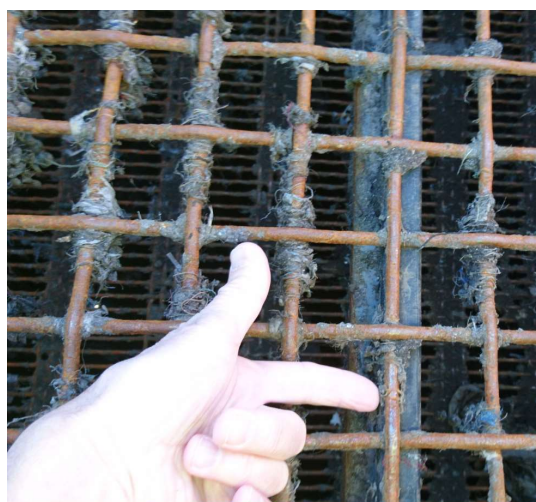
Figur 8. Enkelt såll, 40 mm, i skaksikt
