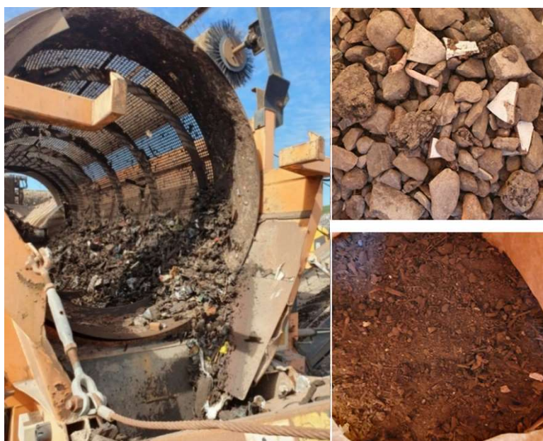
Figur 21. Trumsiktning med såll 20 mm. Överbelastning av sikten riskerar medföra att finmaterial följer med till fraktionen >20 mm.
