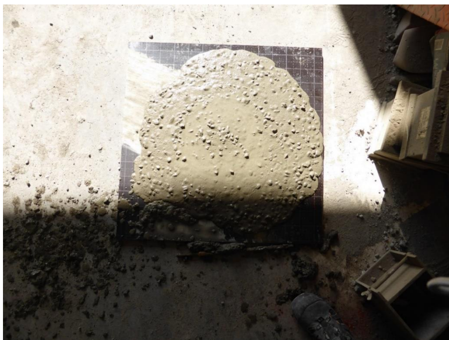
Figur 5.7 Flytsättmått av betongmix 5.
