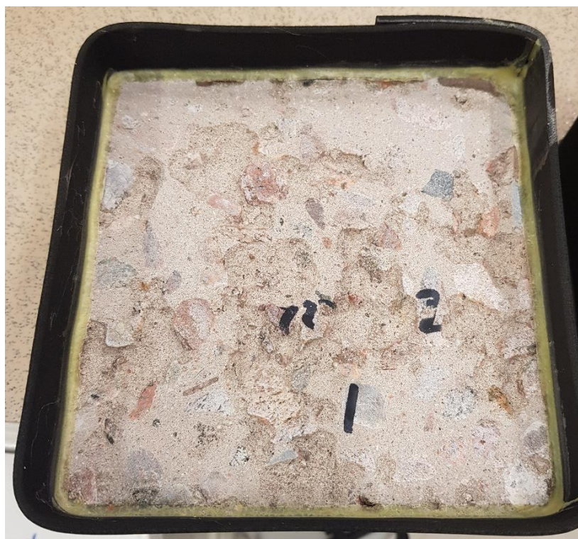
Figur 5.10 Delprov 1 från frostresistensprovning.
