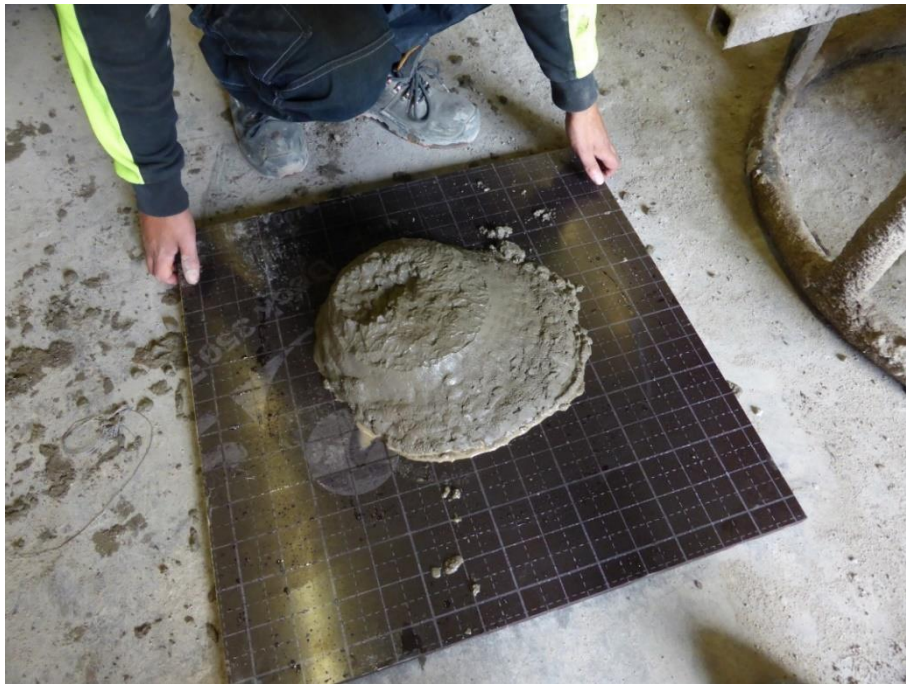
Figur 5.5 Flytsättmätt av betongmix 3.
