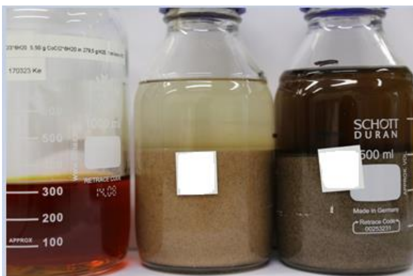
Figur 2.6 Exempel för provning av humus. Här visas Prov B-Ny och B-Rest i jämförelse med referenslösning längst till vänster.
