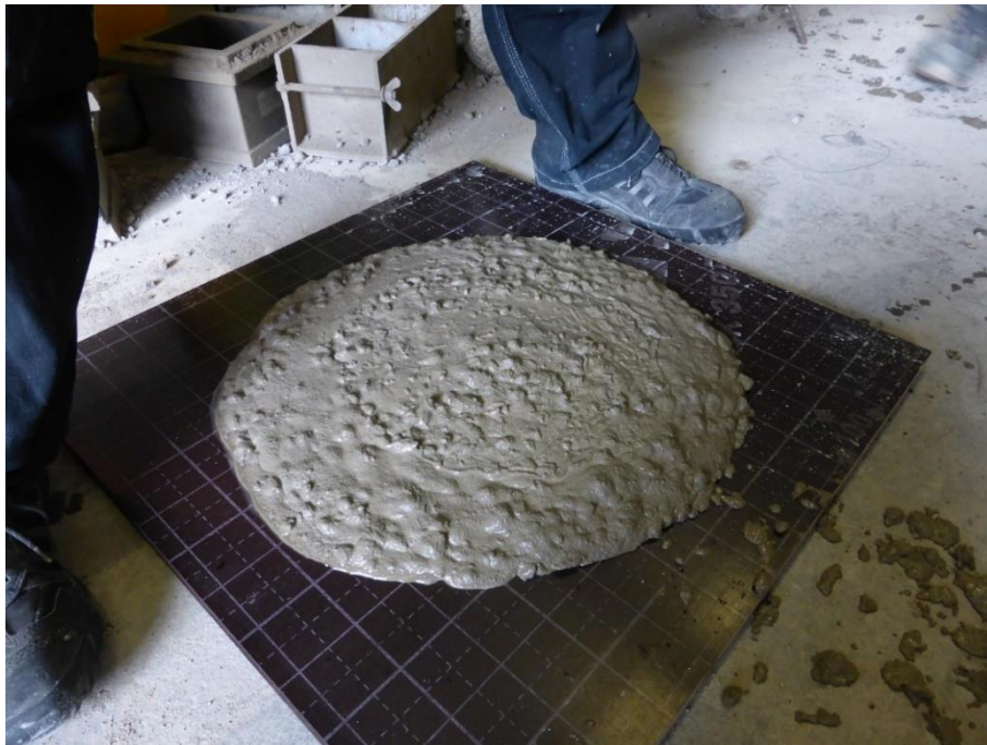
Figur 5.4 Flytsättmätt av betongmix 2.
