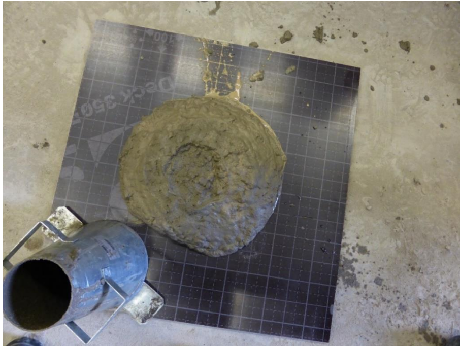
Figur 5.3 Flytsättmätt av betongmix 1.
