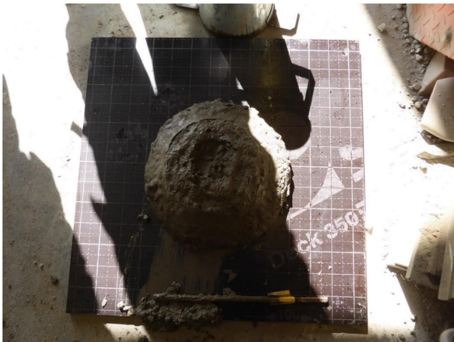
Figur 5.6 Flytsättmätt av betongmix 4.
