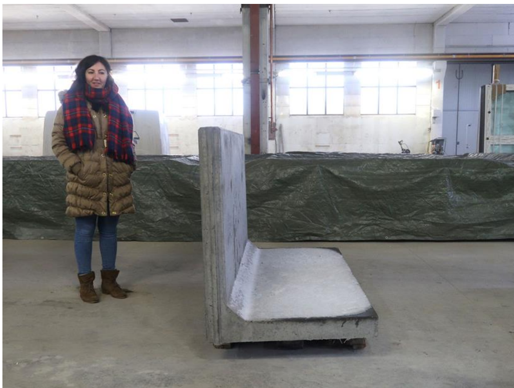
Betongstöd tillverkat med gjuterisand som finfraktion i ballastmaterialet.
