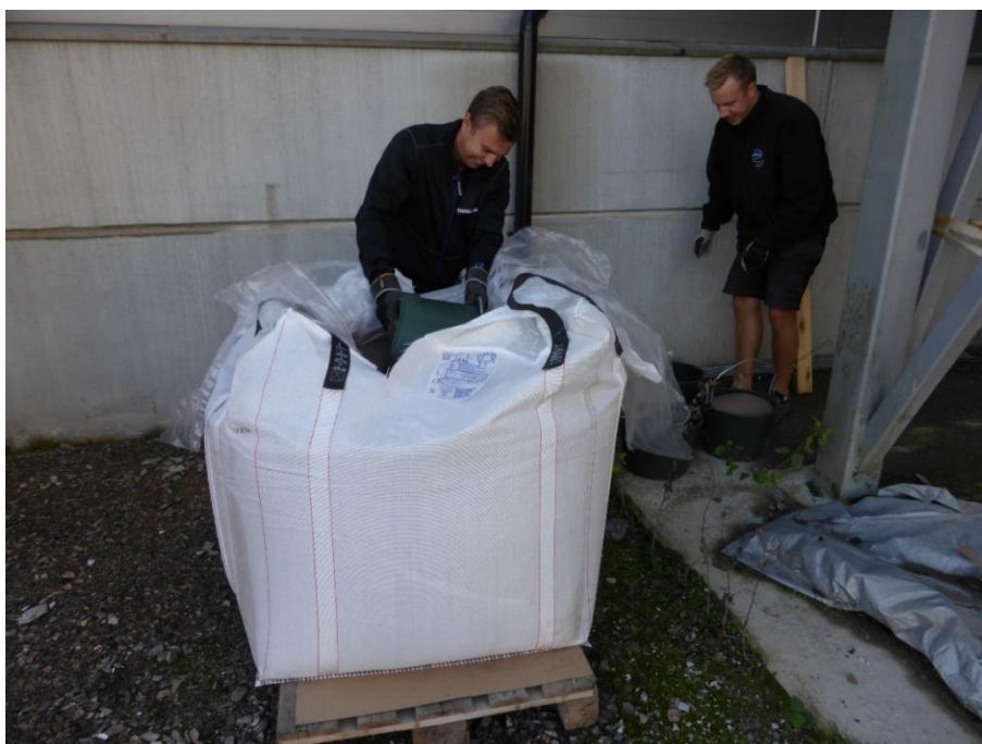
Figur 5.1 Manuell uppvägning och matning till transportband av gjuterisand.
