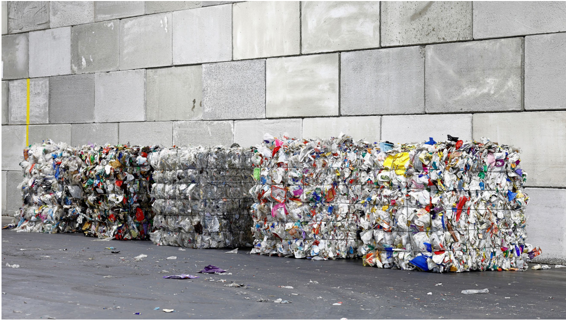
Figur 2. Sorterade plastfraktioner i balad form hos Site Zero, Svensk Plaståtervinning. Balarna är ca 1 kubikmeter och väger drygt 500 kg styck. Provtagningen fokuserade på sorterade plastfraktioner; inkommande osorterat material inkluderades inte i studien. Under cirka ett år togs månadsvisa stickprov från balar vid Site Zero av de producerade mjukplastfraktionerna LDPE, PP-film och PO75 samt hårdplastfraktionerna HDPE, PP och PO50. Stickproven togs från enskilda balar, där en borrhög användes för att extrahera delprov ur balen. Borrhögen möjliggör att delprovet representerar material från flera olika objekt i balen.
