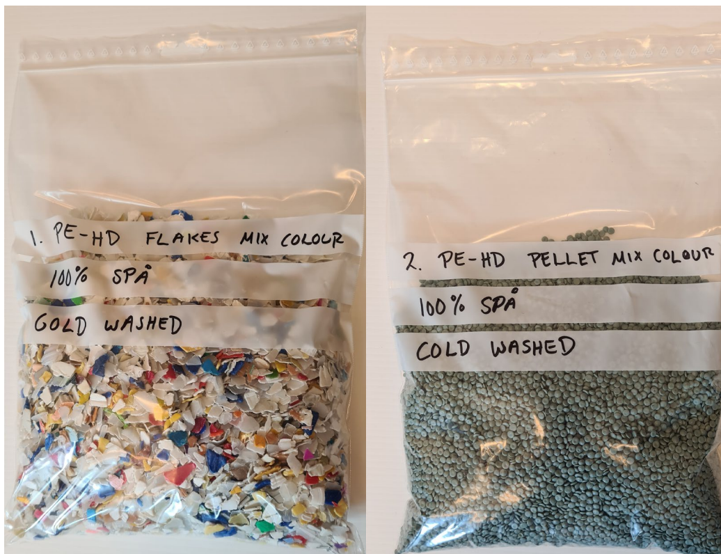
Figur 9. Tvättade plastflingor (t.v.) och plastpellets (t.h.) från mekanisk återvinning av HDPE.
