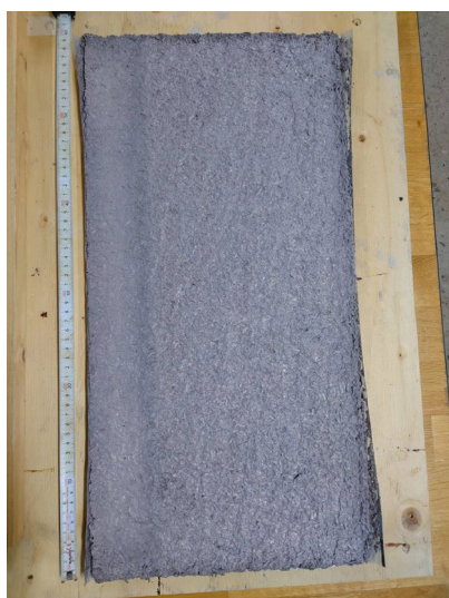
Figur 31. Skivmaterial som till stor del består av återvunna gipsskivor, biokol och kalk.
