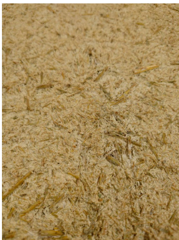
Figur 30. Skivmaterial som till stor del består av återvunna gipsskivor, hö och kalk.
