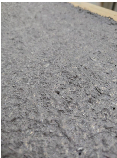
Figur 31. Skivmaterial som till stor del består av återvunna gipsskivor, biokol och kalk.
