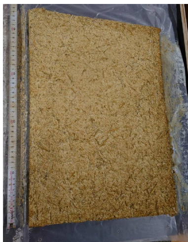
Figur 30. Skivmaterial som till stor del består av återvunna gipsskivor, hö och kalk.
