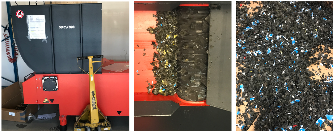
Figur 3. Test av mekanisk kvarning av skidhjälm i RISE lab i Mölndal A) Utrustning, B) Shredder, C) Resultatet i form av schreddat mix-material.
