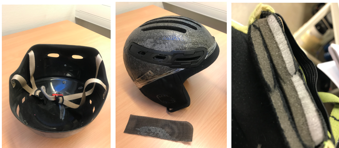
Figur 2. Delar av isärmonterade skidhjälm A) ABS-skall, B) Diverse komponenter fastlimmade på EPS-cellplasten, C) Öronskydd med PUR-skum limmat med polyester-foder.
