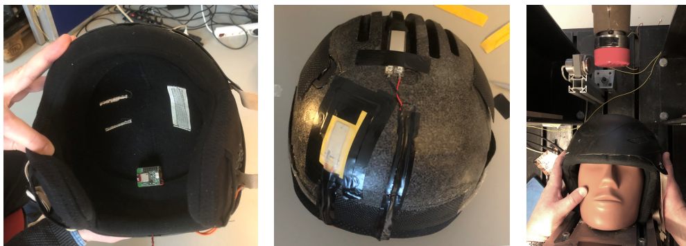
Figur 1. A) Elektronik för avläsning och kommunikation (BLE), B) Sensorfilm, C) Mätning med prototyp på krockhuvud.
