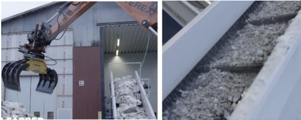
Figur 2. Inmatning till shredder/riv och vidare transport av fragmenterad film till tvättanläggningen.
