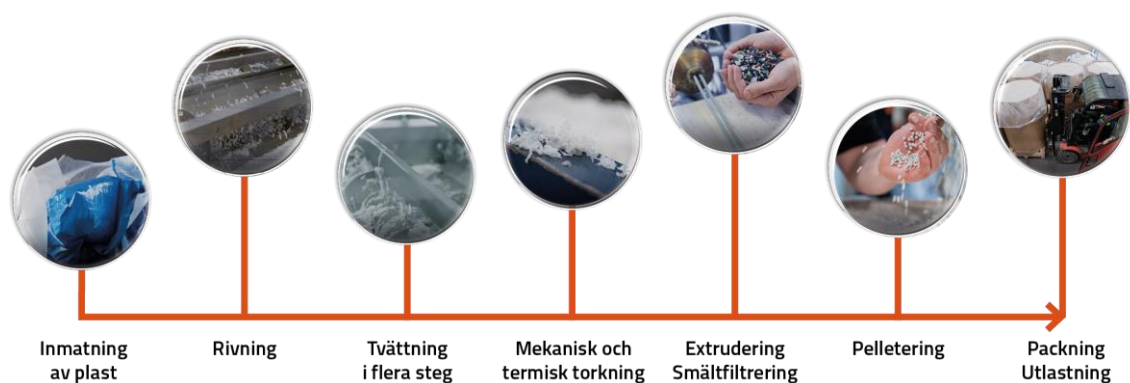
Figur 4. Principskiss med de processteg som ingår i återvinningsanläggningen på Reviva Plastics.
