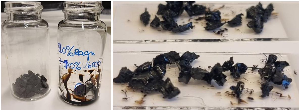
Figur 6: Förbehandling av gummigranulat med bitumen enligt procedur i Uppsala
