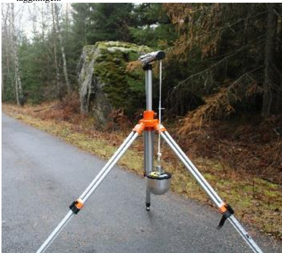
Figur 3: HIC (Head Injury Criterion)-utrustning för bestämning av Kritisk Fallhöjd
