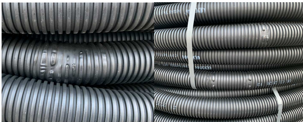
Figur 20: Kabelskyddsror tillverkade av material som innehöll föroreningar.
