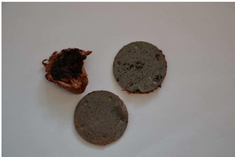
Figur 16: Alla gummipartiklar separerades inte bort genom sink-float separationen utan en del fastnade i compounderns smältfilter, se figur 15 nedan.
