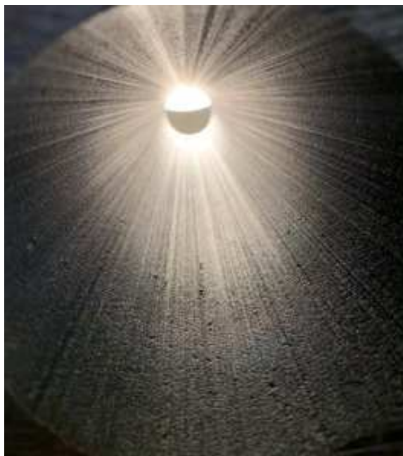
Figur 22: Insidan av ett kabelskydds rör av återvunnen Polyeten.
