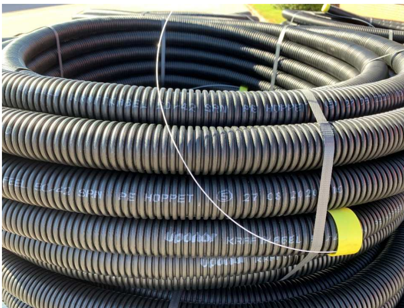
Figur 21: Bilden visar ett korrugerat kabelskyddsror av Polyeten (PE) tillverkat av Uponors produktionsspill. Att röret är flexibelt gör att man kan lägga det i kuperad mark utan att behöva krökar mm för att följa nivåskillnader i marken. Rören är märkta med "Hoppet".
