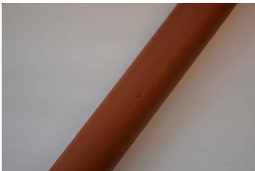
Figur 17: visar ett PP-rör med en av de större föroreningarna som fanns.
