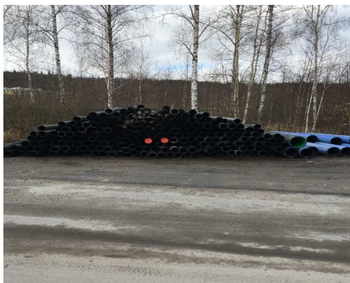
Figur 10: Dricksvattenrör av Polyeten hos NPG i Jönköping.
