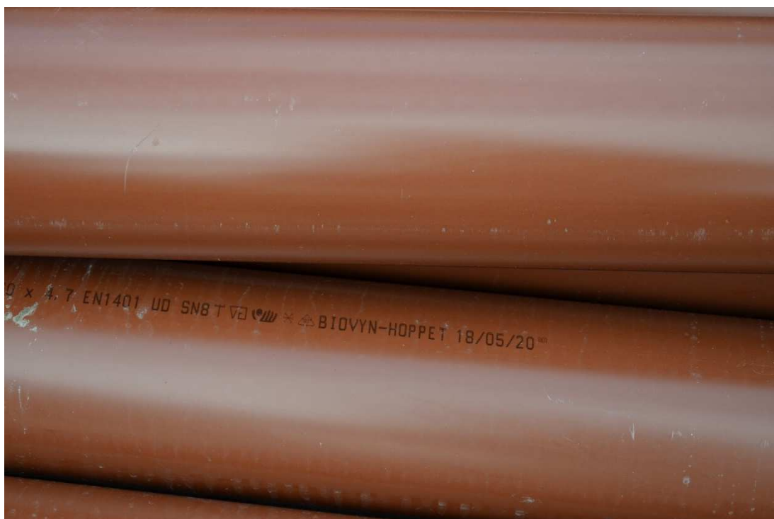
Figur 7. Rör tillverkade av Biovyn från Inovyn, bioattribuerad PVC, dvs tillverkade av fossilfri råvara.
