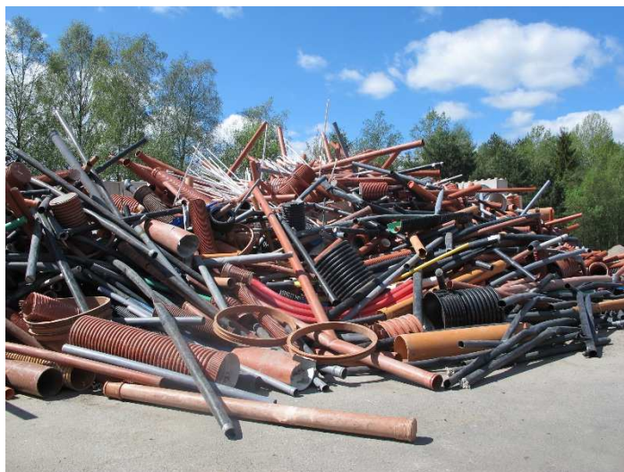
Figur 9: Stora mängder blandade rör hanteras hos Van Werven, rören lastas av på marken och grovsorteras först med maskin och därefter för hand. Vid hanteringen blir rören smutsiga och att avgöra vilka som är spill eller uppgrävda är svårt.
