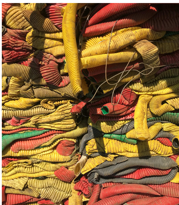
Figur 13: Återvunna och utsorterade korrugerade rör. Dessa ska till malning och tvätt för att kunna materialåtervinnas. På grund av formen så fastnar mycket jord och smuts på denna typ av rör.
