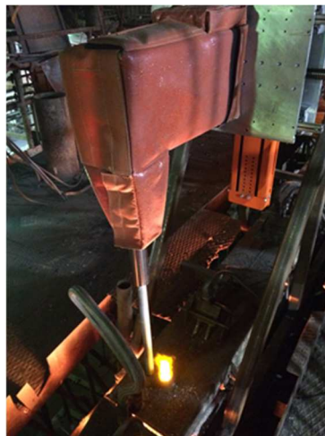
Figur 1. LIBS-instrument installerat för kontinuerlig analys av slaggsmäta vid tappränna.
