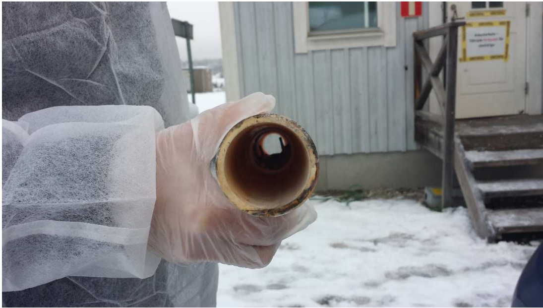
BILD 1. Ett av de keramiska rören till rörugnen med ett fastbränt prov inuti röret. Bilden är tagen utanför asbestlabbet på SÖRABs återvinningsstation.
