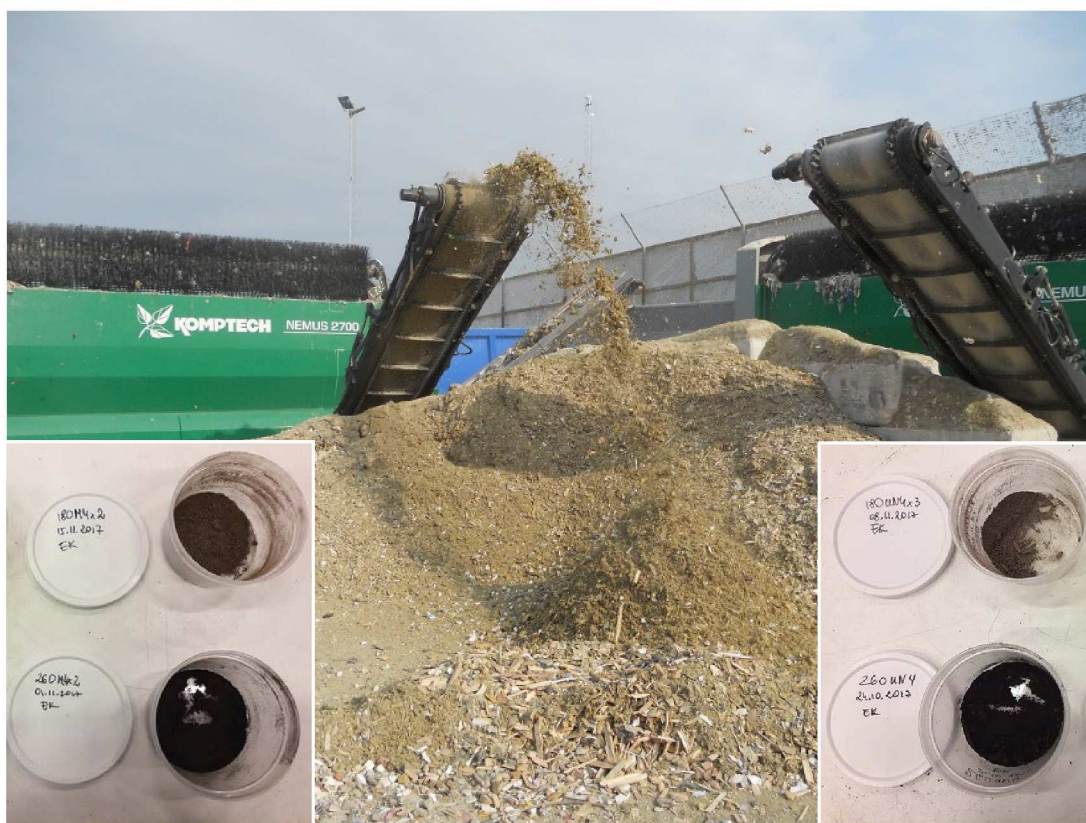
Figur 1 Finfraktion från bygg- och rivningsavfall som testades i detta projekt och exempel på hur materialet såg ut efter HTC-behandlingen: ljusare efter HTC vid 180°C och nästan svart efter HTC vid 260°C
