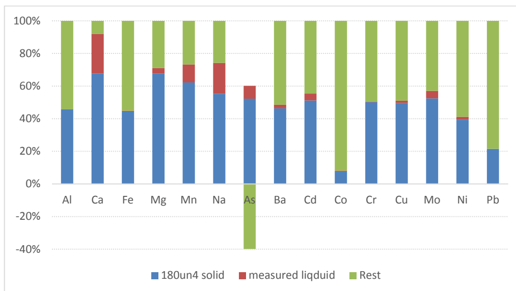
Figur 9 Fördelningen av element efter HTC av omalet material vid 180°C och L/S 4.
