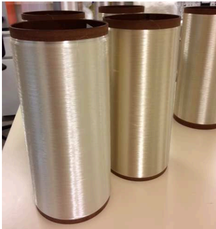
Spolar med fiber smältspunnen från återvunnen förpacknings-PET.
