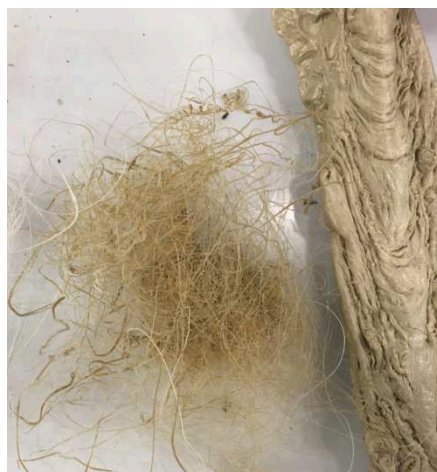
Figur 6. Smältfiltrerad förpacknings-PET. Brun färg kommer av brända etiketter.
