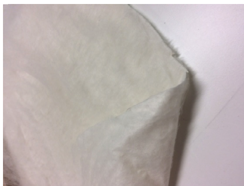
Figur 10. Nonwoven framställd via melt blown av återvunnet polyesterspill.
