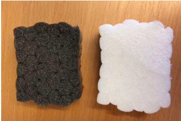
Figur 14 visar skum framställda hos Diab med 10% återvunnen PET till vänster och av 100% nyråvara till höger.
