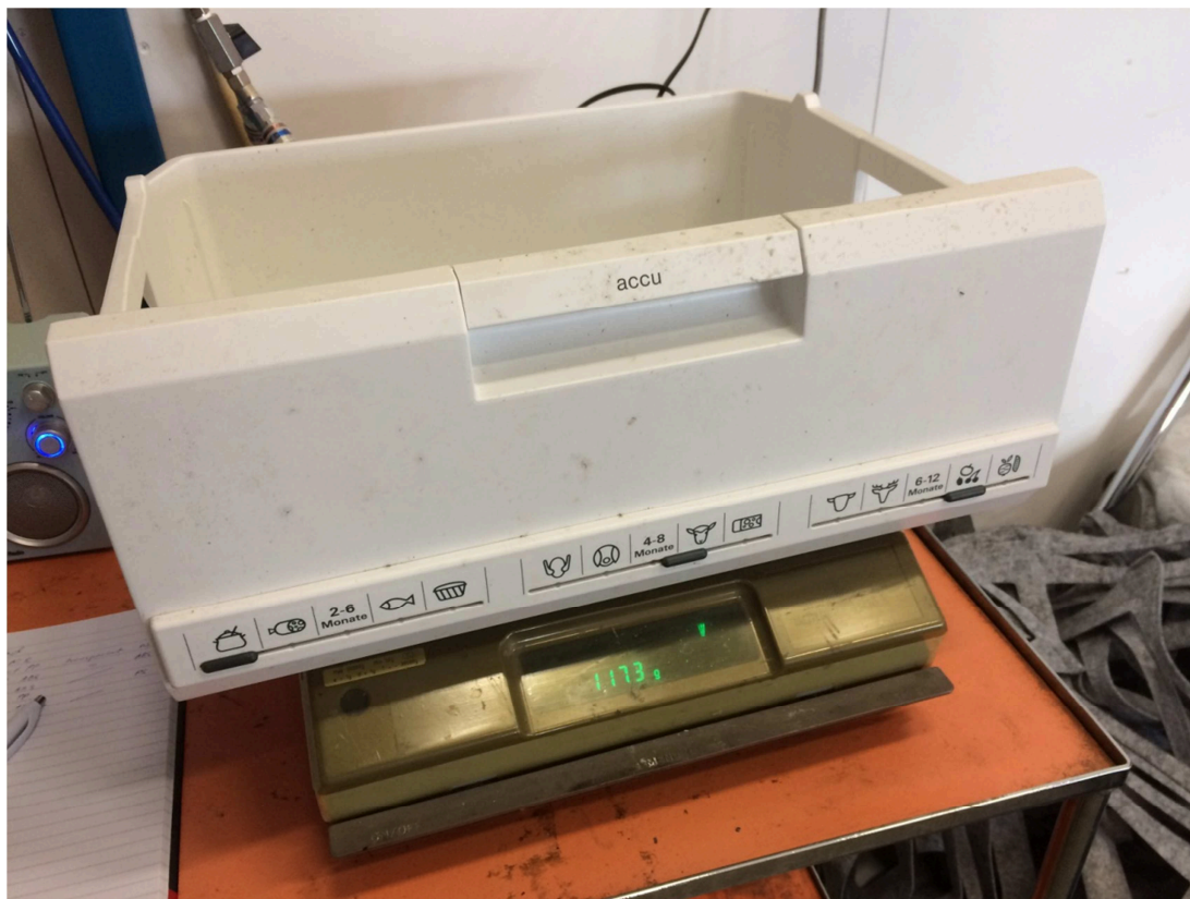
Figur 1 Sorteringsförsök 1. Lådorna sorterades efter plasttyp och vägdes.
