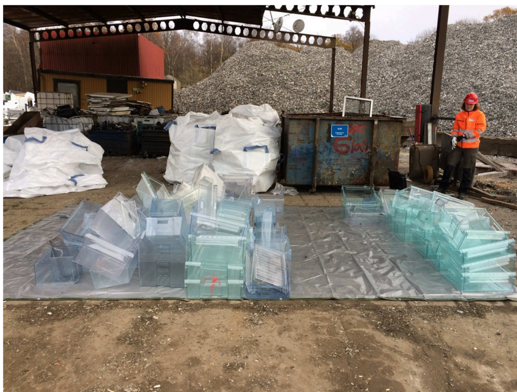
Figur 2. Plockanalys 2 på Stenas anläggning i Halmstad under hösten 2017. De transparenta lådorna sorterades till vänster för PS och till höger för SAN.
