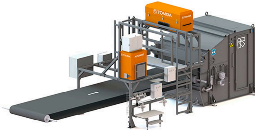
Figur 4. Bilden visar en typ av automatiserad teknik som kan användas för sortering av mindre plastkomponenter och -produkter 2 .
