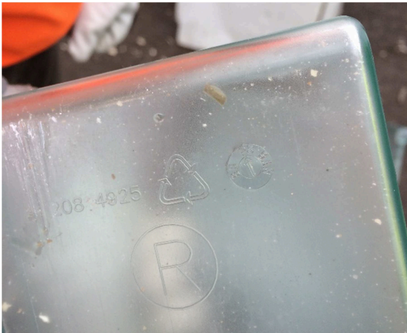
Figur 3. Bilden visar hur en märkning av plasttyp kan se ut. Märkningen ses längst till höger och utgörs i detta fall av att en pil är riktad mot den plasttyp som lådan är konstruerad av. För just denna låda pekar pilen mot PS och de övriga två plasttyperna som ses i märkningen är SAN och SB.
