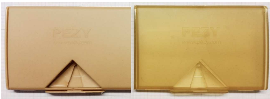
Figur 2. Exempel på produkter skapade från PHA producerad från restströmmar. Formulering med 74 % PHA (vänster) och PLA med 15 % PHA (höger). Från tidigare publicerad rapport (Bengtsson et al., 2017b) med medverkan från Pezy Group.
