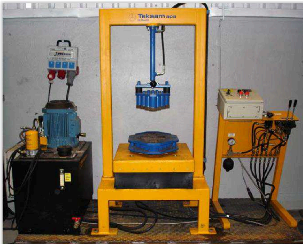
Figur 1. Utrustning för tillverkning av försöksbriketter - Teksam VU600/6
