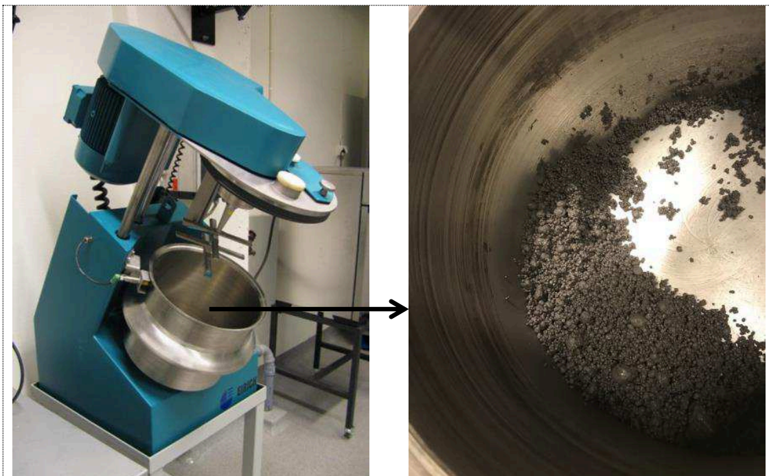
Figur 13. Bildade granuler i Eirich-mixer RV02E (fraktion F3, test 1).
