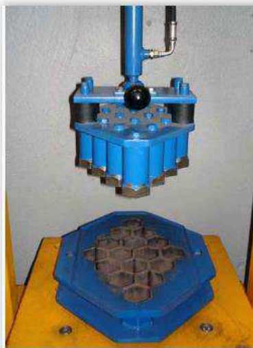
Figur 2. Brikettpress och form för 16 briketter
