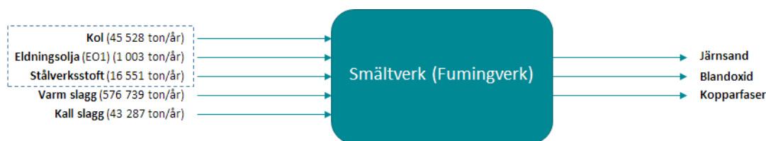
Figur 2. Övergripande beskrivning av Bolidens materialåtervinning (fumigprocess) i fallstudie 2.
