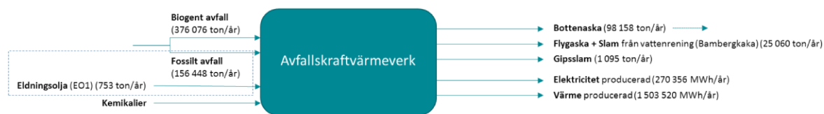
Figur 4. Övergripande beskrivning av Renovas avfallskraftvärmeverk i fallstudie 3.
