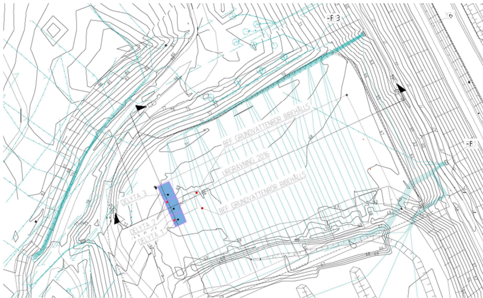
Figur 9. Befintligt uttagssystem för biogas från BCR01. Ledningar från olika delar och nivåer sammanförs till en reglerstation (RB13).
