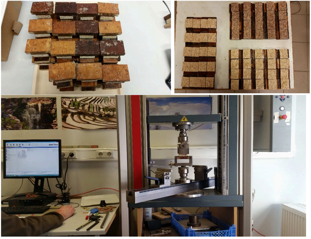
Figure 31. Determination of internal bond (IB) strength (EN 319).
