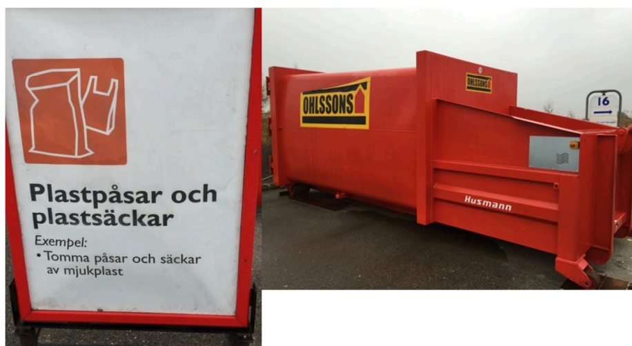
Figur 6. Sorteringsanvisning samt komprimator för mjukplast på Bunkeflo ÅVC.
