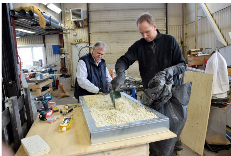
Fig. Här sker en test av att direktgjuta PUR-isolering i en av våra Ecovativepaneler.
